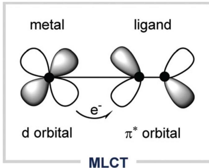
•传统MLCT（metal-to-ligand charge transfer）途径：金属催化剂需要历经系间跃迁和外层单子传递，把光能转化成化学能，过程中伴随着光能的部分损失。
