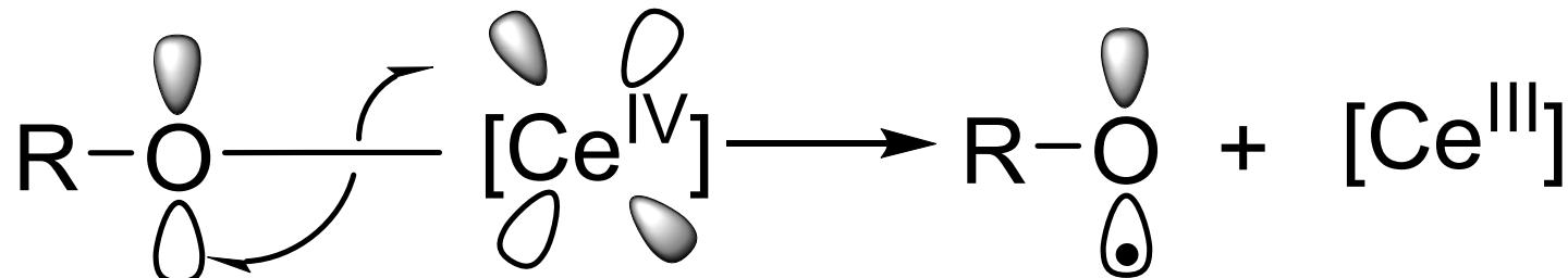
•铈和醇参与的LMCT（ligand-to-metal charge transfer）途径：光照射后诱导配位键均裂形成有机自由基物种，减少中间态，从而最大程度地利用光能。
