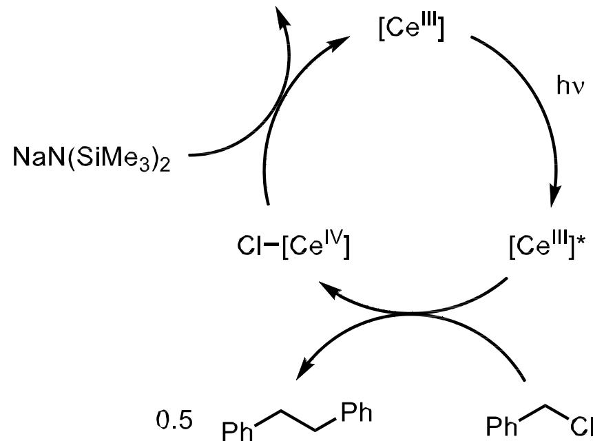
内层电子传递过程，反应中 Ce(IV)-Cl 键的形成促进了 C(SP<sup>3</sup>)-Cl 键的活化
