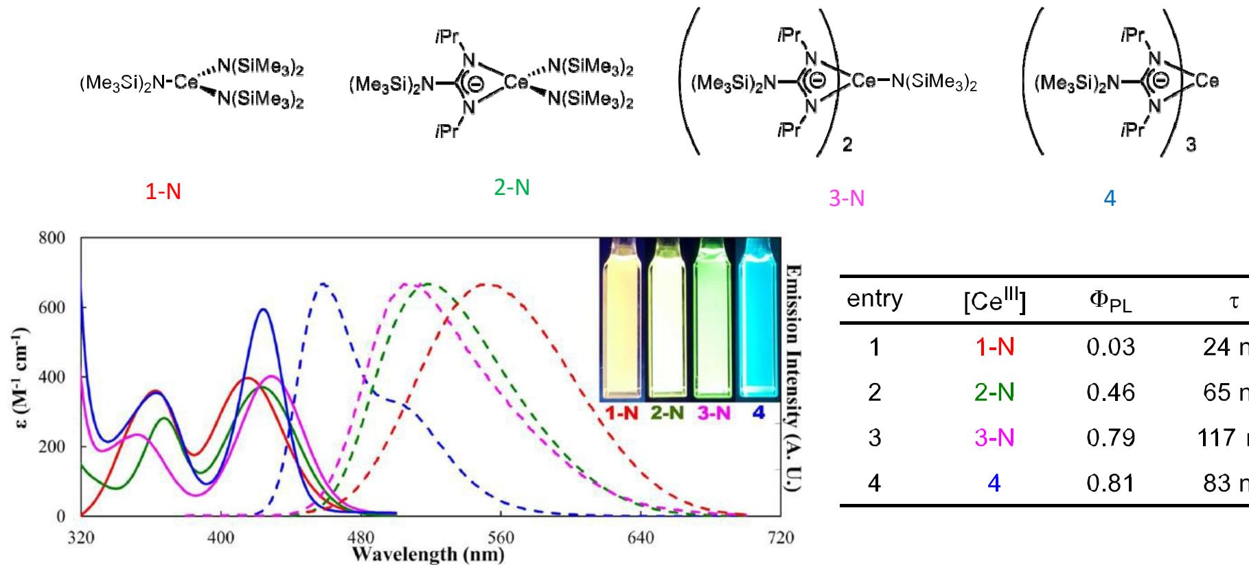
•铈配合物的发光颜色由配体类型和结构的刚性决定
